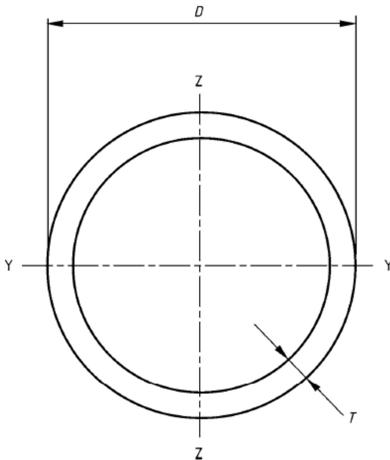
Рисунок В.1- Полый профиль с круглым сечением
