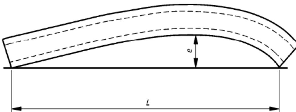
**Рисунок 8- Измерение отклонения от прямизны**
