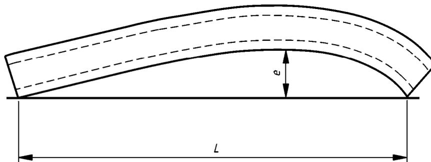
**Bild 8 — Messung der Abweichung von der Geradheit**
