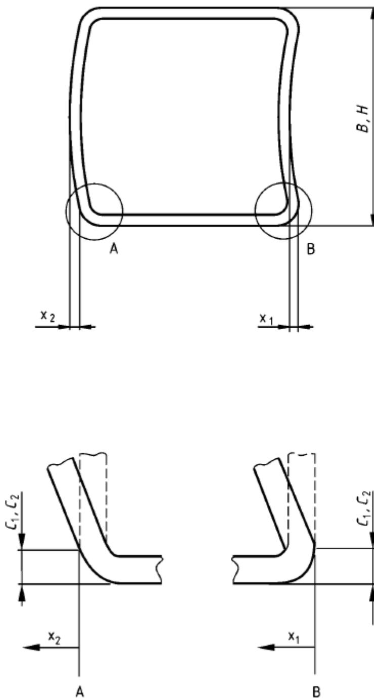
Рисунок 2- Измерение вогнутости или выпуклости полых профилей с квадратным или прямоугольным сечением
