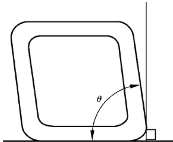
Рисунок 3- Прямоугольность сторон полых профилей с квадратным или прямоугольным сечением
