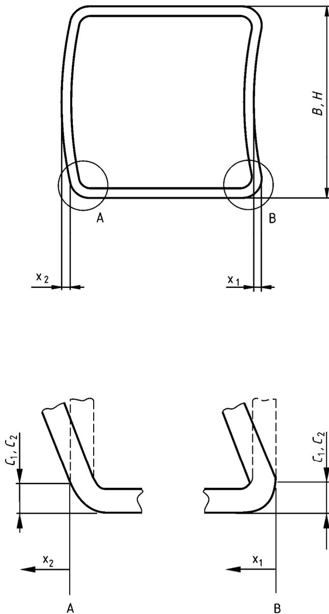
**Bild 2 — Messung der Konkavität bzw. Konvexität von Hohlprofilen mit quadratischem oder rechteckigem Querschnitt**
