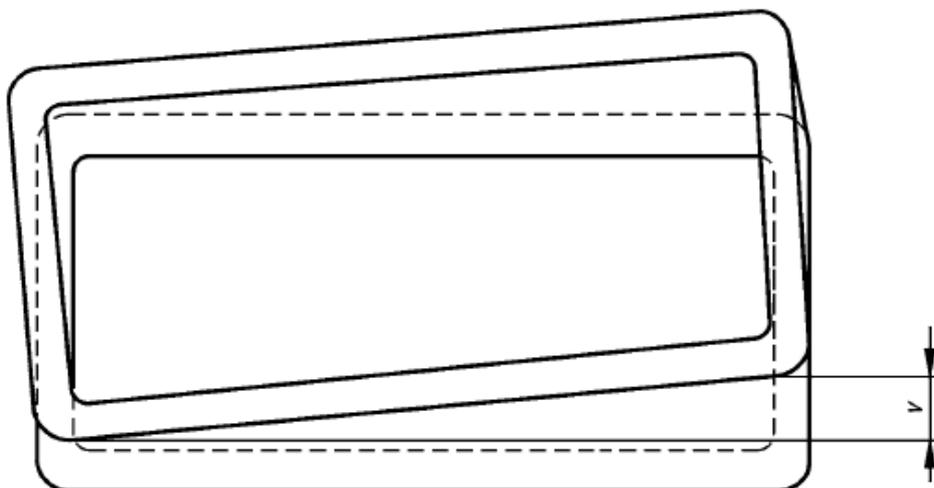
Рисунок 5- Скручивание полых профилей с квадратным или прямоугольным сечением
