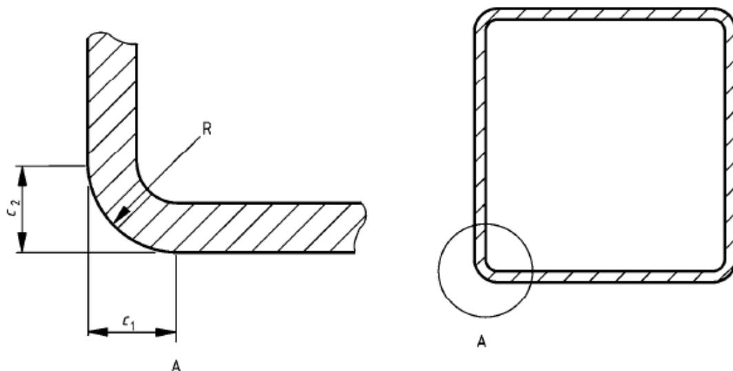
Рисунок 4- Наружный закругленный профиль в полых профилях с квадратным или прямоугольным сечением
